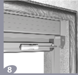
Assemblare gli zoccoli. Unire SX INT con SX EST e DX INT con DX EST
