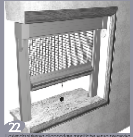
Le guide dovranno scivolare tra l'aletta della testata e quella della cuffia
