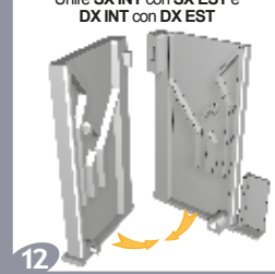
Ruotare i regolatori di 90 gradi
