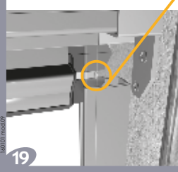
Nel caso si verificasse la risalita inclinata della barra maniglia oltre gli 8/10 mm si consiglia di aggiungere 1-2 bottoni antivento manuali (disponibili su ordinazione in confezioni da 100 pz.)
