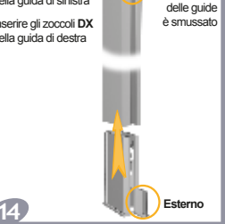
Con la chiave esagonale agire sui regolatori per ottimizzare la posizione delle guide
