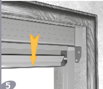
ATTENZIONE: Per un corretto funzionamento accertarsi che il cassonetto sia ben appoggiato alle guide telescopiche
