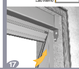
Le guide dovranno scivolare tra l'aletta della testata e quella della cuffia
